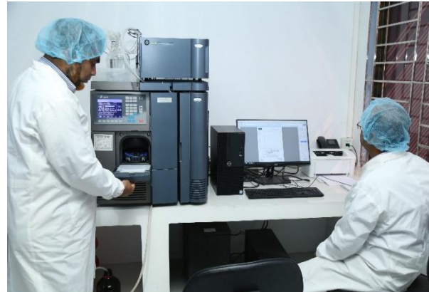
চিত্র-৮ (২): রেসিডিউ ও বায়োলজিকস্ শাখায় High-Performance Liquid Chromatography (HPLC) মেশিন দ্বারা নমুনা পরীক্ষা
