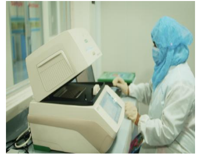
চিত্র-১০ (৩)ঃ মাইক্রোবিয়াল ফুড সেফ্টি শাখায় Real-Time PCR দ্বারা নমুনা পরীক্ষা
